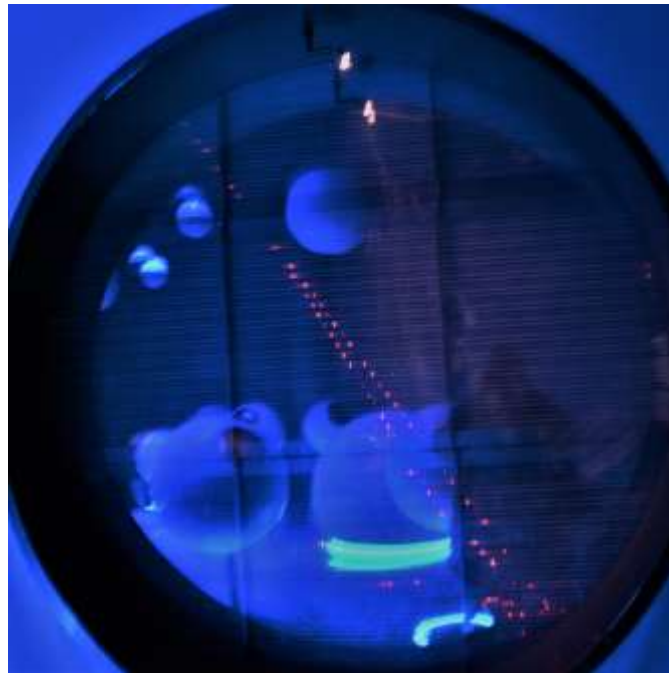
Traces des muons cosmiques enregistrées par la chambre à bulles.
